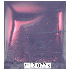
图11 实验26气体浓度达到峰值时样品的阴燃状态
